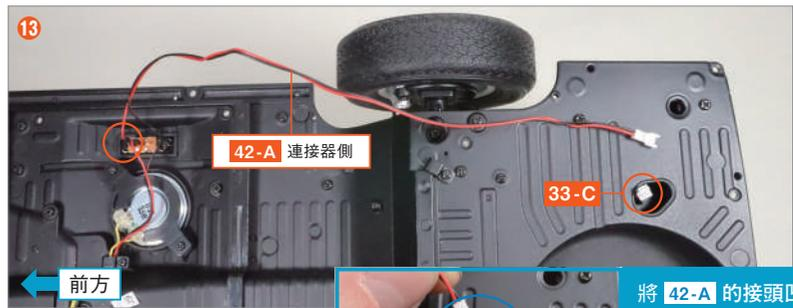
將 42-A 的接頭側的電線接上電池盒 33-C 的接頭。
