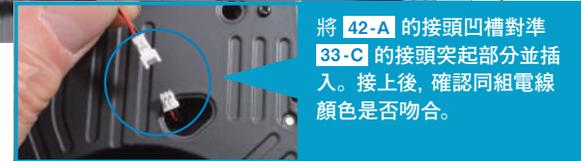
將 42-A 的接頭凹槽對準 33-C 的接頭突起部分並插入。接上後，確認同組電線顏色是否吻合。
