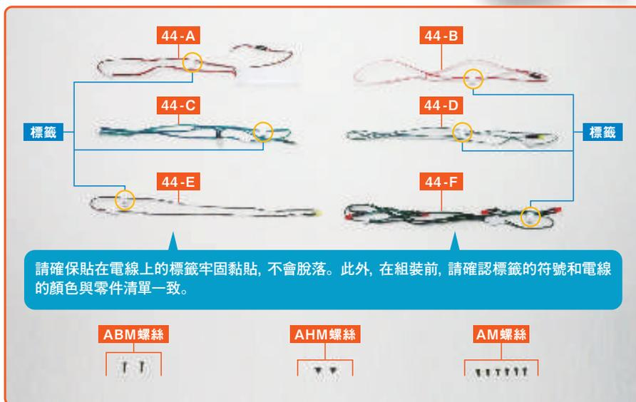
請確保貼在電線上的標籤牢固黏貼，不會脫落。此外，在組裝前，請確認標籤的符號和電線的顏色與零件清單一致。
